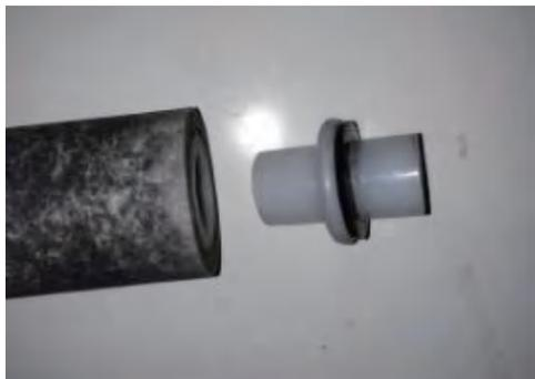
(6) 装新滤芯，装上上下堵头，带黑色密封圈的堵头在下方，注意滤芯上下垫圈不能缺失；先把过滤器中的水排放掉，再把新滤芯装进过滤器中；
