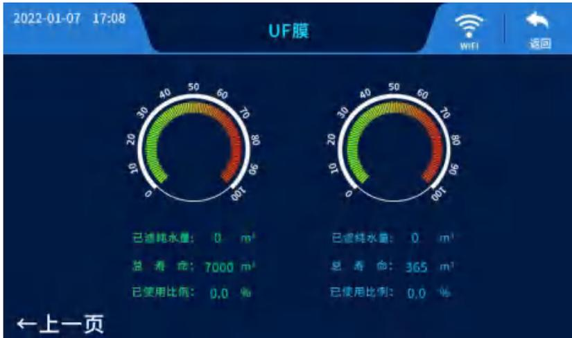
2、运行状态界面：运行状态界面可查看用水量数据、设备进水水压、膜后压力数据。此处展示用水量界面。
