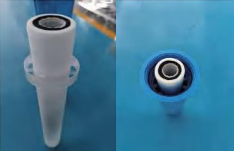
(4) 将装好滤芯的滤瓶用滤瓶扳手顺时针上紧；
