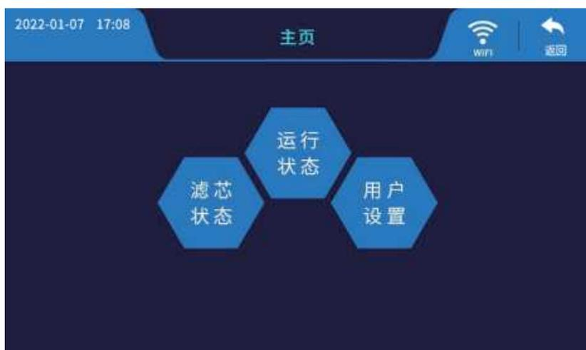
1、滤芯状态界面：可展示活性炭、精密滤芯、UF膜、软化树脂、再生盐使用寿命数据。此处以LOSUF-2000-S UF膜使用寿命数据为例展示界面。
